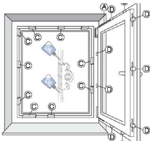
Ici l'image montre la disposition des points de graissage possibles, qui doivent être huilés au moins une fois par an. Les points A et D sont les plus importants.
